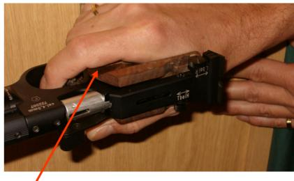
Sollte der Abzugsfinger mit dem Grund- oder Mittelglied am Griff anliegen, muss an dieser Stelle Material entfernt werden
