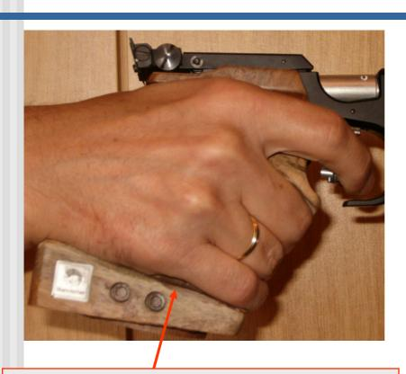
Handballenauflage durch verschieben oder Materialauftrag genau anpassen
