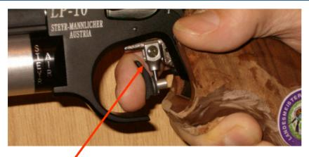
Die richtige Lage des Endgliedes des Abzugsfingers wird durch verschieben des Abzugszüngels eingestellt
